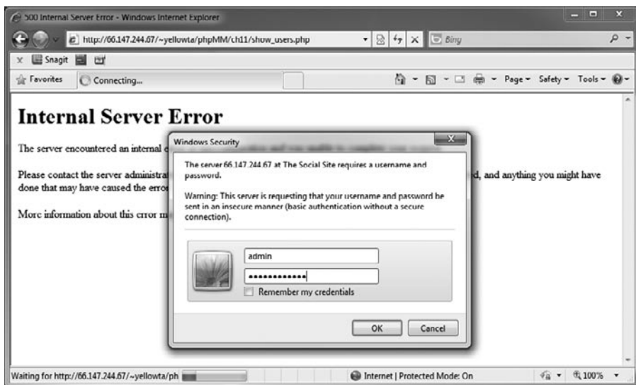
Рис. 11.4. Браузер отвечает на ваши заголовки окном регистрации и передает значения интерпретатору PHP посредством сверхглобальной переменной $_SERVER
